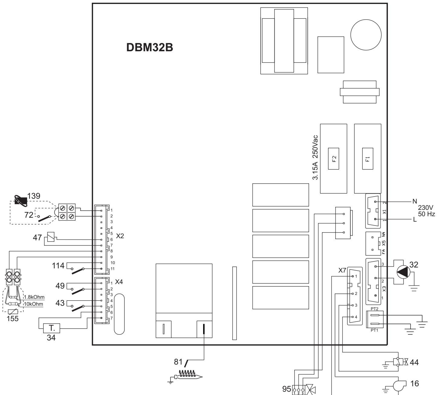
fig. 24 - Esquema eléctrico
