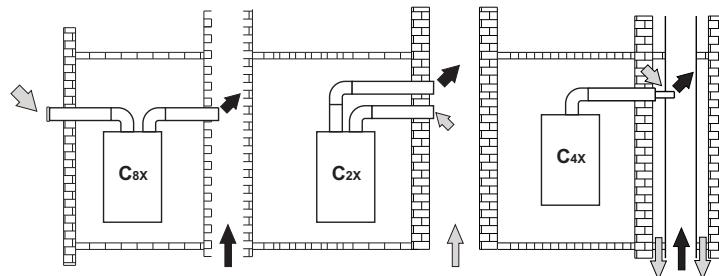
fig. 14 - Ejemplos de conexión a chimeneas (➡ = aire / ➡ = humos)
