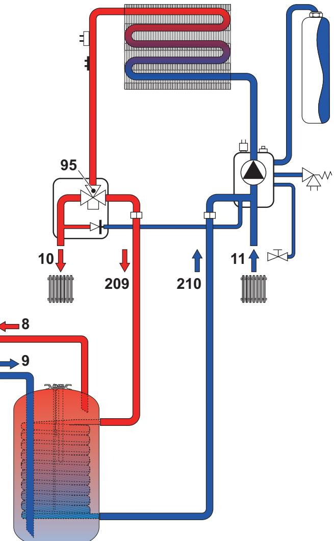
**fig. 7 – Esquema de ligação a um esquentador externo**
