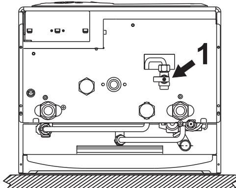
**fig. 6 – Torneira de enchimento****3. INSTALAÇÃO****3.1 Disposições gerais**
