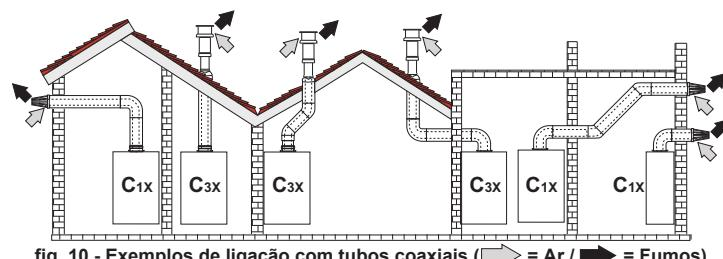
fig. 10 - Exemplos de ligação com tubos coaxiais (➡ = Ar / ➡ = Fumos)
