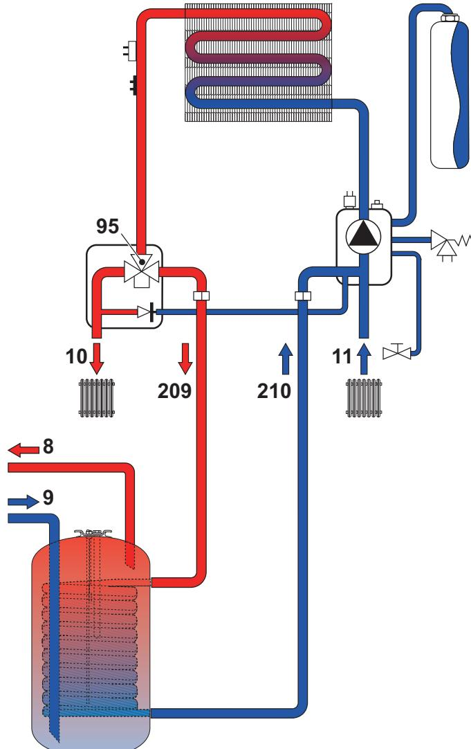
fig. 7 - Esquema de conexión a un termostanque externo
