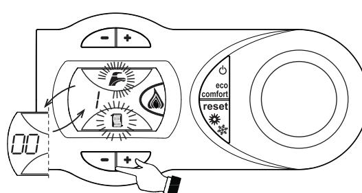
fig. 15 - Modalidad TEST (potencia de la calefacción = 100%)
