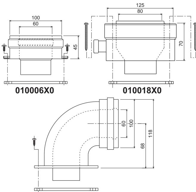
fig. 11 - Accesarios iniciales para conductos coaxiales
