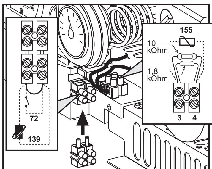
fig. 9 – Acesso à régua de terminais
