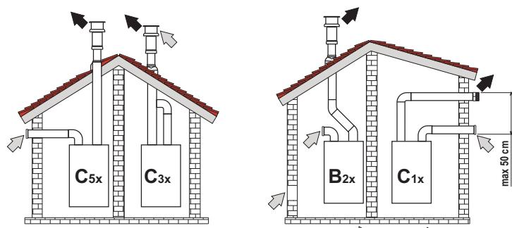
fig. 12 - Exemplos de ligação com tubos separados (➡ = Ar / ➡ = Fumos)
