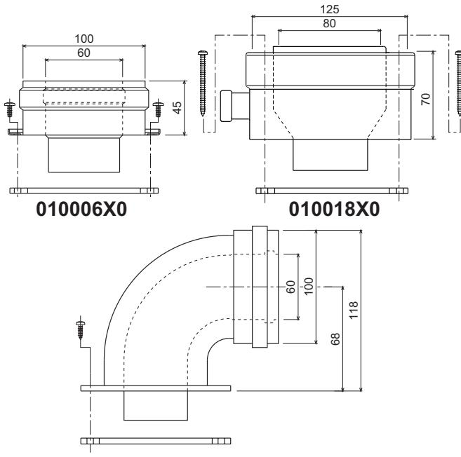
fig. 11 – Acessórios iniciais para condutas coaxiais
