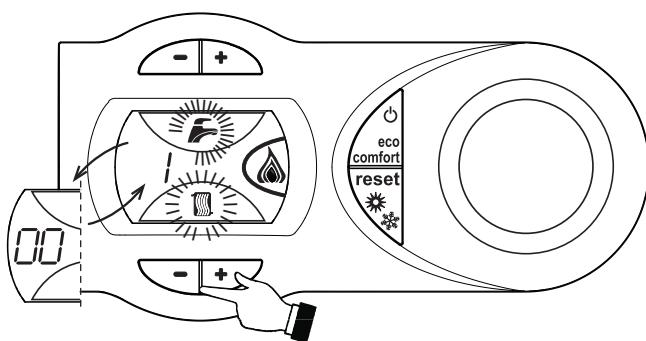
fig. 15 – Modo de TESTE (potência de aquecimento = 100%)
